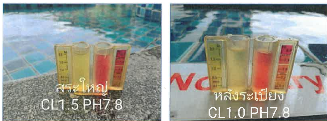
ภาพถ่ายที่ 3.4.3-1 การตรวจเช็คค่าความเป็นกรดต่างและคลอรีนอิสระคงเหลือ ของสระว่ายน้ำประจำวัน
